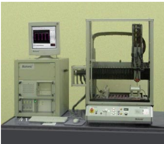
DIASTAR 3300 Schutzgehäuse, Fenster mit pneumatischer Öffnung und Steuereinheit
