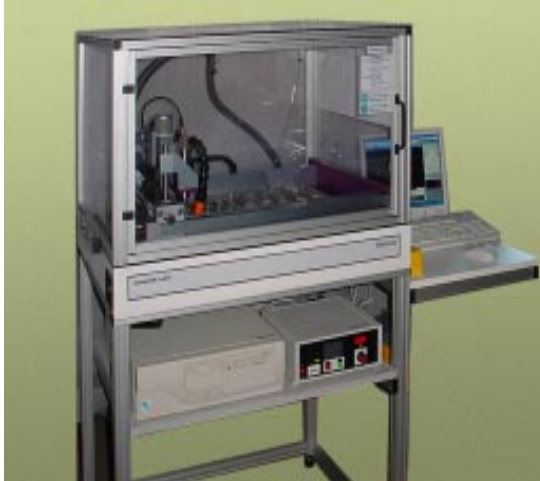
DIADRIVE 2000 mit U1-Maschinenunterbau, Schutzgehäuse, PC, LCD, SF-Spindelgenerator und Diavac 800K
